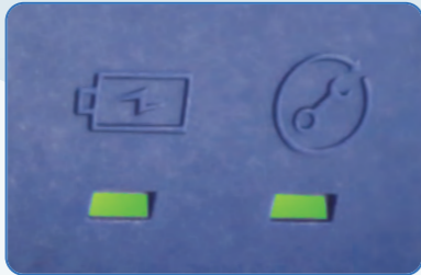
Les voyants de contrôle visuel permettent de vérifier l'état de charge de la batterie et la nécessité d'une intervention de maintenance.
